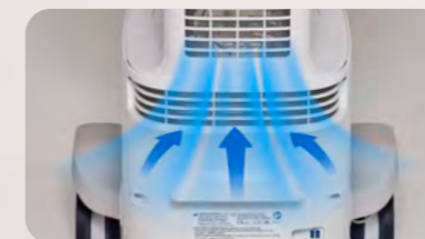
Optimisation de la ventilation de l'échographe
